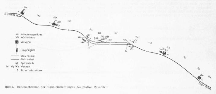
fahren der Einfahrweiche. Sobald diese durch den Zug wieder verlassen ist, beginnt eine Verzögerungszeit abzulaufen, nach welcher die Weiche wieder automatisch zur Umsteuerung freigegeben wird. Diese Zeitverzögerung wurde eingeführt, damit nicht eine feindliche Fahrstrasse einlaufen kann, bevor der eingefahrene Zug zum Stillstand gekommen ist. Haltstellung und Fahrstrassenauflösung der Ausfahrt erfolgen gleichzeitig beim Verlassen der Ausfahrweiche 3.
