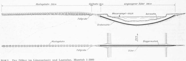
Bild 1. Der Düker im Längsschnitt und Lageplan, Masstab 1:3000
