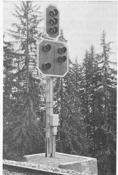
Bild 6. Einfahrtsignal D 1/3 mit angebautelem Vorsignal B*. An der Rückseite des Signalma- stes Telephonapparat zur allfälligen Verständigung zwischen Zugspersonal und Fahrdienst- leiter
