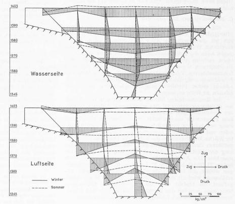
Bild 7. Wasser- und luftseitige Normalspannungen an der Staumauer Sufers auf Grund eines fünfschnittigen radialen Lastausgleichs und für zwei Temperaturzustände bei
