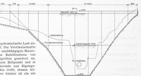
Bild 3. Längsabwicklung der Staumauer Sufers, 1:1000
