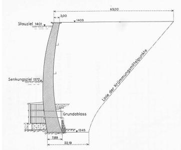
Bild 4. Hauptschnitt 1:1000 der Staumauer Sufers
