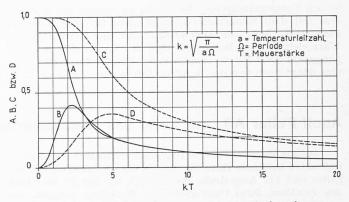
Bild 9. Amplitudenreduktionsfaktoren zur Temperaturberechnung
