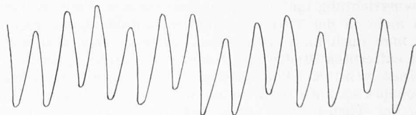
Bild 9. Originaldiagramm, aufgenommen am gleichen Ort und unter genau gleichen Umständen, wenn mit der kleinsten Glocke (IV) allein geläutet wird. Die dreimal so rasch wie die Glockenpendelung erfolgenden Turmschwingungen sind hier viel stärker als die von der Glocke I herrührenden (ein Pendel ist hier noch nicht eingebaut)
