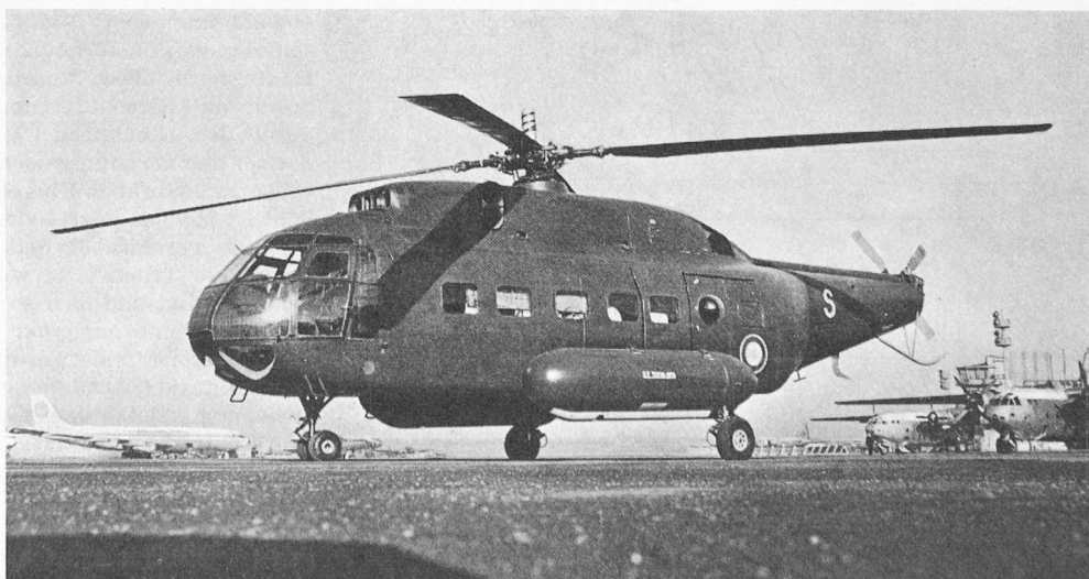
Bild 9. Der schwere Hubschrauber «SE 3200 Frelon», für 3 t Nutzlast oder 20 bis 30 Passagiere
