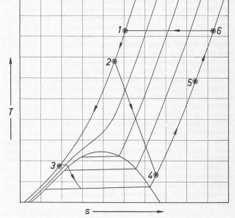
Bild 2. Entropie-TS-Diagramm für Luft Die Zahlen bezeichnen die im Text beschriebenen Zustände
