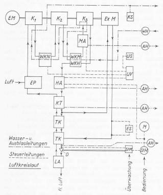
Bild 1. Schaltungsschema der Luftverflüssigungsanlage
