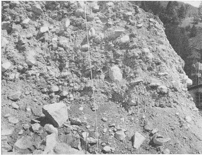
Bild 8. Gutes Aushubmaterial, für Dammschüttung geeignet
