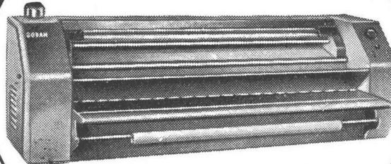
Papierdurchlass 110 cm. Leistung pro Min. 40—130 cm, max. Geschwindigkeit pro Min. 0—180 cm, Lichtquelle 4 x 65 Watt mit Reflektor, Anschluss 220 Volt, 2 Amp., Stromverbrauch 300 Watt, Länge 170 cm, Tiefe 50 cm, Höhe 54 cm, Gewicht 137 kg
