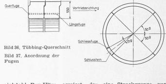
zialstahl Box-Ultra armiert, der eine Streckgrenze von 5000 kg/cm² und eine Zugfestigkeit von 6500 kg/cm² besitzt, und aus einem Spezialbeton mit einer minimalen Würfeldruckfestigkeit nach 28 Tagen von 450 kg/cm² hergestellt. Die zulässigen Spannungen wurden wie folgt festgesetzt:
