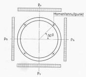
Bild 32. Symmetrische Belastung am vollen Kreisring
