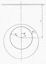
Bild 29. Druckverteilung nach Caquot
