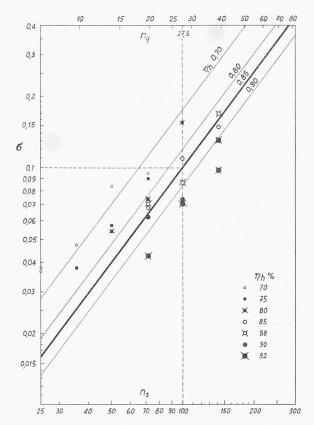
Bild 2. Thomascher Kavitationsbeiwert  $\sigma=(A-H_t-\Delta h)/H$  in Abhängigkeit der spez. Drehzahl  $n_s$  oder  $n_q=n_s/3$ ,65. Die kräftig ausgezogene Linie für Pumpen  $\eta_h=0$ ,85 entspricht den Versuchen von C. von Widdern²)
