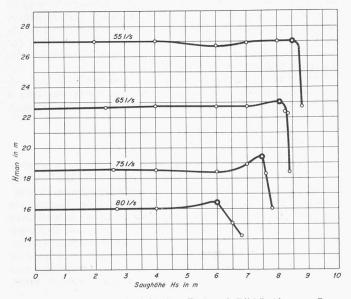
Bild 5. Saugversuche mit «Fiscalin»-Rad nach Bild 5. Als max. Saughöhe  $H_s$  wird jeweils der Punkt kurz vor dem Steilabfall der Kurve betrachet. Atmosphärendruck  $A=9.9~\rm m$
