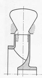
Bild 8. Einbau eines «Fiscalin»-Rades mit einfach gekrümmten Schaufeln in eine Serienpumpe. Entsprechend der grösseren Laufradaustrittsbreite musste das Spiralgehäuse behelfsmässig ausgedreht werden
