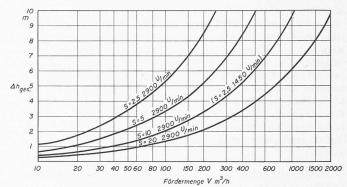
Bild 10. Gesamthaltedruckhöhe  $\Delta h_{ges}$  in Abhängigkeit der Fördermenge für  $S=2.5,\ 5,\ 10$  und 20 bei 2900 U/min
