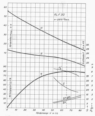
Bild 7. Leistungsversuche mit Rad nach Bild 6. Die  $H_{\mathfrak{s}}\text{-}\mathrm{Kurve}$  wurde aus Bild 5 erhalten
