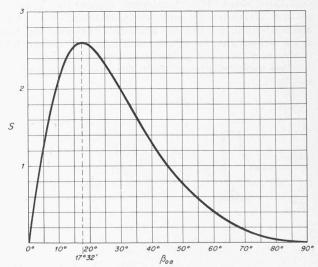
Bild 3. Saugzahl S in Abhängigkeit von Zuströmwinkel  $\beta_{0a}$  für  $\lambda_1=0.30$  und  $\lambda_2=1.20$
