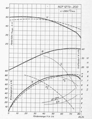
Bild 9. Leistungskurve mit Rad nach Bild 8. Die ursprüngliche Saughöhe des Normalrades konnte stark verbessert werden; gleichzeitig wurde die Stabilität erhöht.  $V=67,\ S=8,\ \lambda_1=0,109$
