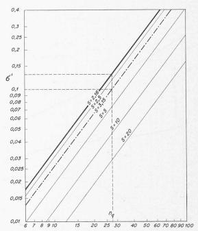
Bild 4. Thomascher Kavitationsbeiwert  $\sigma=(A-H-\Delta h_{g\circ s})/H$  und Pfleiderer-Saugzahl S in Abhängigkeit der spez. Drehzahl  $n_q$ . Die kräftig ausgezogene Kurve aus Bild 2 entspricht den Werten C. von Widdern oder einer Pfleiderer-Saugzahl S=2.18 beim Nabenverengungsgrad k=0.75 und  $\Delta h_{g\circ s}/\Delta h=\sim 1.3$ . Für eine bestimmte spez. Drehzahl  $n_q$  sind je nach Saugzahl S beliebige o-Werte möglich
