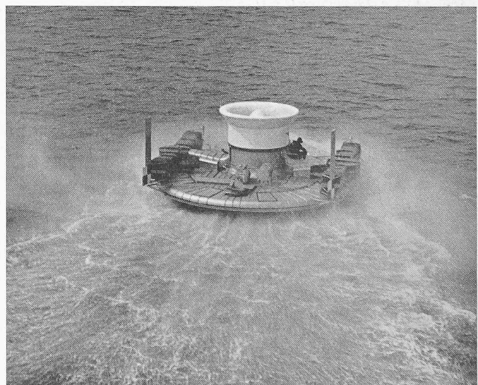
Bild 1. SRN-1 Hovercraft von Saunders-Roe bei einer Fahrt über Wasser. Als unerwünschte Begleiterscheinung äussert sich dabei der das Fahrzeug einhüllende Sprühregen
