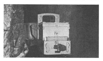
Diese Betonnachmischer für den Stollenbau gibt es in 3 verschiedenen Grössen: für 1,5, 2,6 und 4 m³ Beton. Der Trommel-Antrieb erfolgt durch einen geräuscharmen Druckluftmotor, der nur 10,5 m³/min. verbraucht. Die robuste Reversiertrommel (7 mm-Blech) kann im Stollen einwandfrei entleert werden.
