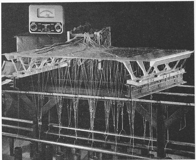
Bild 3. Elektr. Dehnungsmessungen am Plexiglasmodell 1:50
