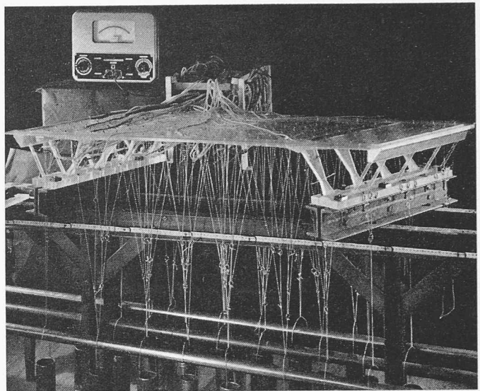
Bild 3. Elektr. Dehnungsmessungen am Plexiglasmodell 1:50
