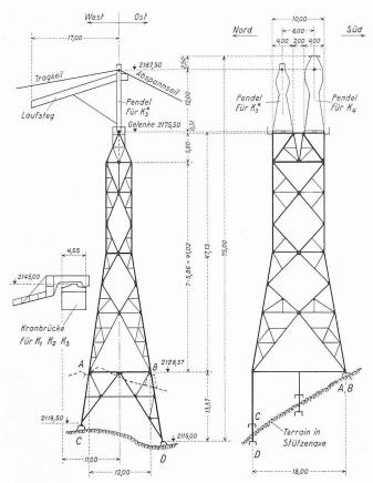
Bild 3. Kabelkran-Turm Ost, Masstab 1:800
