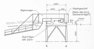
Bild 6. Schematischer Querschnitt 1:250 des Ueberbaues der Brücke
