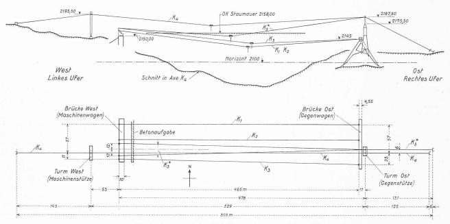
Bild 1. Uebersicht der Kabelkrananlage, Masstab 1:5000 Bild 2 (unten). Brücke und Turm auf dem rechten (östlichen) Ufer
