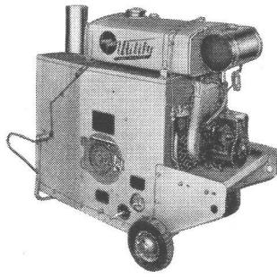
Für **Austrocknung von Neubauten**
