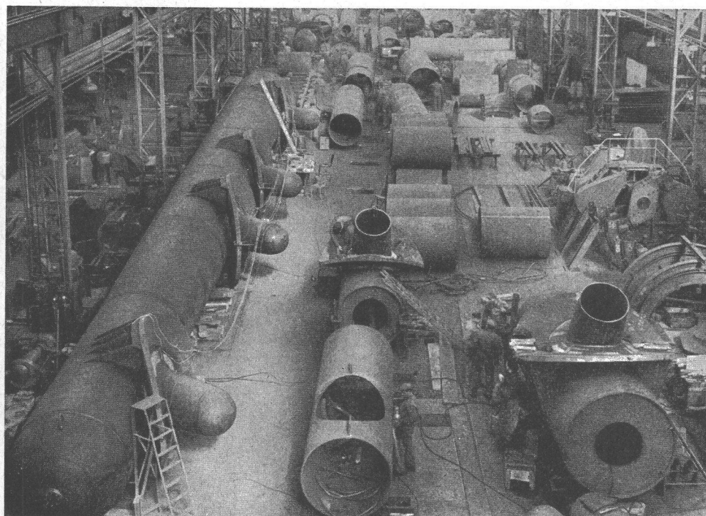
Partie aval du collecteur de la centrale de Fionnay de la Grande Dixence S.A., lors des essais de pression en atelier à 121 atm.
