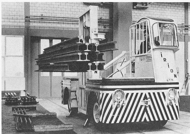
Bild 9. Seitengabelstapler, Tragkraft 5 t. Höchstgeschwindigkeit 25 km/h
