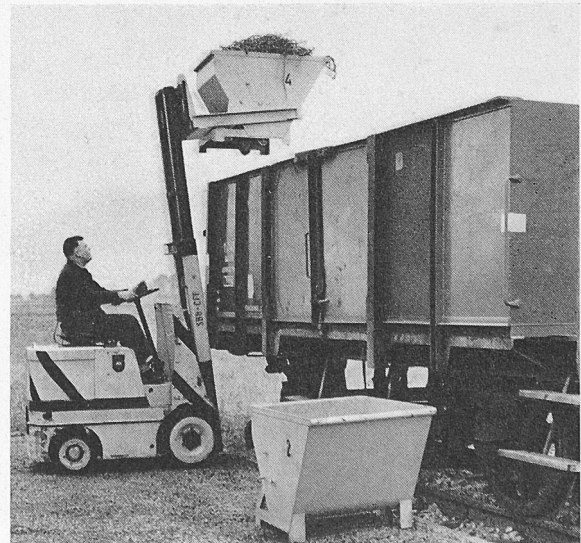
Bild 10. Frontstapler beim Auskippen eines Spänebehälters
