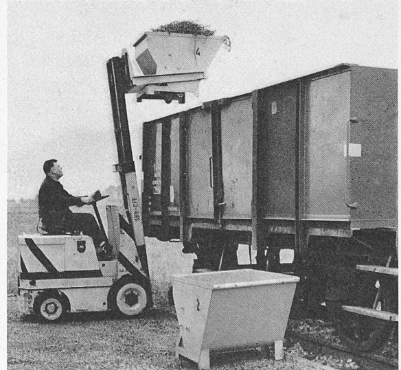
Bild 10. Frontstapler beim Auskippen eines Spänebehälters
