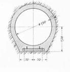
Bild 14. Druckschacht
