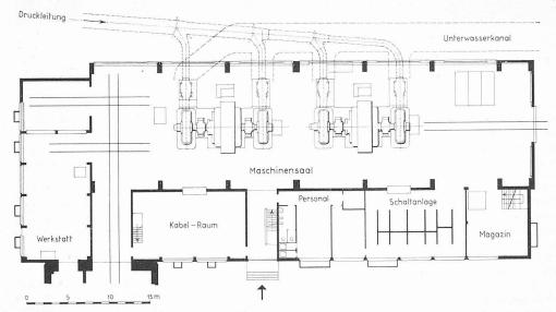
Bild 17. Grundriss 1:500 des Maschinenhauses Ackersand II
