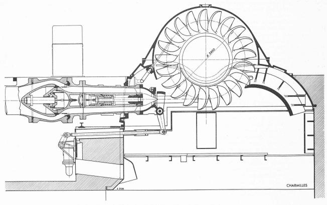
Bild 16. Schnitt 1:60 durch eine Turbine mit Einlauf und Schieber (Bauart Charmilles)
