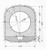
Bild 15. Flachstrecke des Druckschachtes
