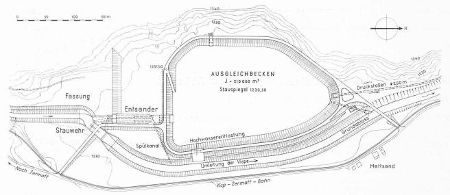
Bild 3. Kraftwerk Ackersand II, Ausgleichbecken Mattsand, Lageplan 1:4500
