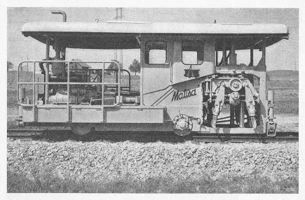
Bild 12. Selbstfahrende Krampmaschine
