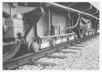
Bild 19. Schleifwagen zum Abschleifen von Riffeln und Wellen
