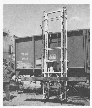
Bild 17. Schwellenauflademaschine
