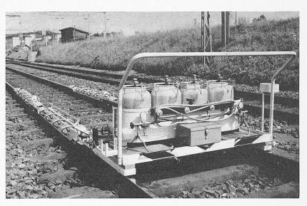
Bild 18. Fahrbares Schienenwärmegerät
