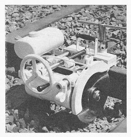
Bild 16. Schienensägemaschine
