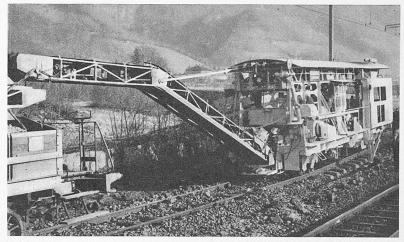
Bild 10. Normalisierter Schienentraktor des Baudienstes mit 95-PS-Dieselmotor
