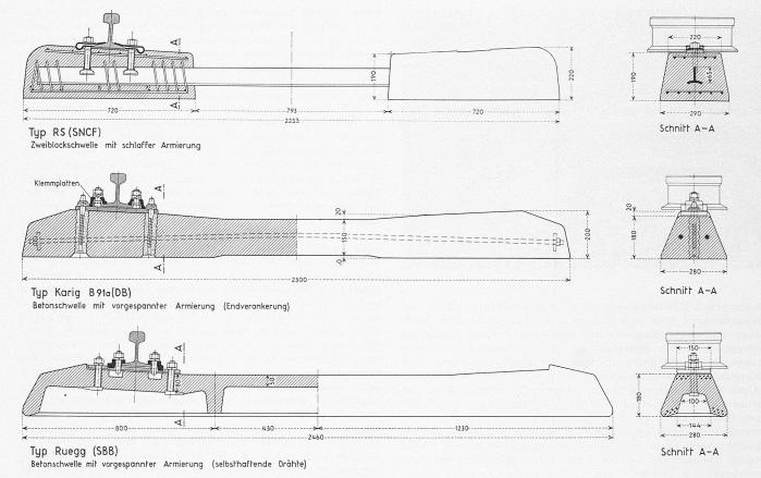
Bild 4. Versuchs-Betonschwellen, drei verschiedene Typen, Masstab 1:17
