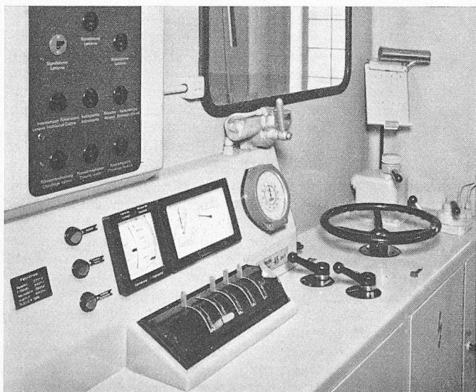
Bild 7. Schützenbatterie für die Schützensteuerung der Lokomotiven 16505/06
