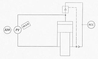
Bild 20. Presse mit direkt gesteuerter, doppeltwirkender Pumpe
