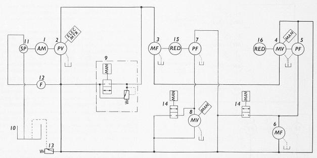
Bild 25. Hauptantrieb und Hilfsantriebe für eine Transparentpapier- Maschine
