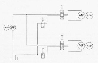
Bild 24. Antriebsschema eines Raupentriebwerks (RED = Reduktionsgetriebe)
