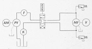
Bild 18. Offener Kreislauf mit von Hand betätigtem Umsteuer- und Bremsschieber, in dessen Mittellage die schwenkbare Pumpe PV auf Ablauf geschaltet und der feste Oelmotor MF hydraulisch festgebremst ist. Die Sicherung des Kreislaufs beim Bremsvorgang erfolgt durch zwei Sicherheitsventile
