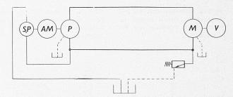
Bild 19. Geschlossener, einfachwirkender Kreislauf
