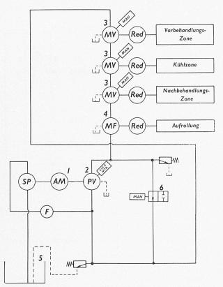
Bild 26. Antriebsschema einer Zellophan-Imprägnierungsmaschine
