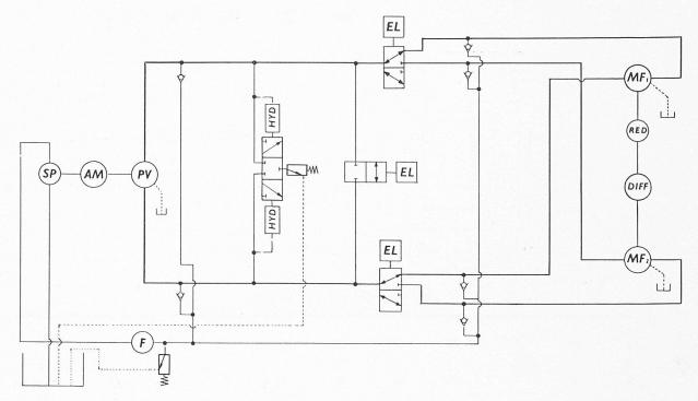
Bild 27. Antriebsschema für besonders grossen Regelbereich mit Differentialgetriebe, dessen eine Eingangsseite rund hundertmal stärker untersetzt ist als die andere.
