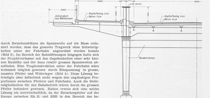
Bild 7. Querschnitt 1:80 bei der Pendelstütze
