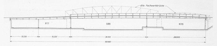
Bild 5. Ansicht der neuen Brücke, Masstab 1:550. Punktiert alte Fachwerkbrücke mit Zwischenpfeilern und Widerlagern.
