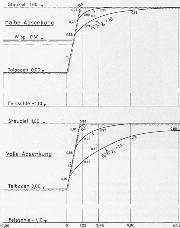
Bild 6. Lage der Sickerlinie in der Böschung nach vollzogener Stauabsenkung in Funktion des Parameters  $k : (a \cdot n \cdot v_a)$ . Nach Versuchen am Spaltmodell 1:200. Fünffach überhöhte Darstellung.
