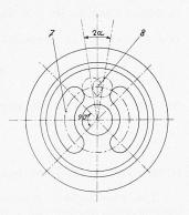
Bild 6. Steuerspiegel
