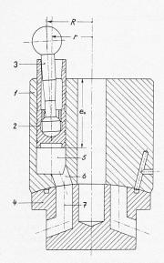
Bild 5. Zylinderblock und Steuerspiegel mit Kolben und Kolbenstangen
