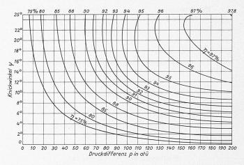
Bild 7. Kurven gleichen Wirkungsgrades der Hydro-Titan-Einheit, Grösse 2507
