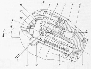
Bild 1. Hydro-Titan-Einheit in axonometrischer Darstellung
