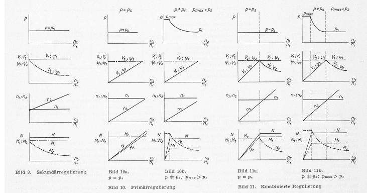
$n_{2\mathrm{max}}$ . Die Drehzahlsteigerung erfolgt bei der Sekundärregulierung durch Verkleinerung des Sekundärvolumens. Reversieren mit dem Sekundärteil allein ist deshalb im Betrieb nicht möglich. Dies müsste mit einem Umsteuerschieber gemacht werden, oder es müsste die Antriebsdrehrichtung umgekehrt werden.
