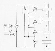
Bild 12 (links). Mehrmotorenantrieb in Parallelschaltung
