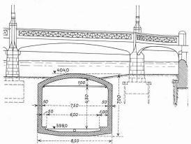
Bild 4. Schnitt 1:300 durch doppelspurige Unterwasserstrasse bei der Rudolf-Brun-Brücke. Höhenlage und Ausbildung des Tunnelquerschnittes sind bestimmt durch das Lichtraumprofil zwischen den Pfeilern, das notwendige hydraulische Abflussprofil und ästhetische Erwägungen (Wasserüberdeckung zwecks Unsichtbarmachung). Es wird angestrebt, den Tunnel so hoch als möglich zu legen
