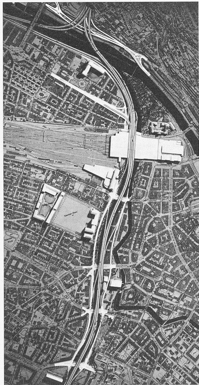
Projektiertes Verkehrsdreieck der Express-Strassen unterhalb des Zürcher Hauptbahnhofes über die Limmat, Ansicht aus Norden (rechts Kornhausbrücke).
