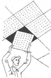
ZENT-FRENGER wird als Unterdecke aufgehängt und ist leicht zugänglich. Elektrizität, Wasser usw. können unsichtbar montiert werden.
