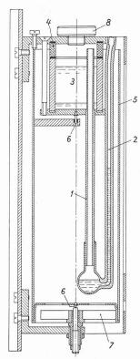
Bild 9. Schnitt durch den Feuchtigkeitsmesser
