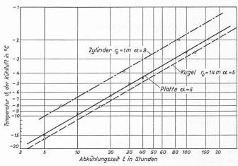
Bild 4. Abkühlungszeiten t, die nötig sind, um die Sandstein-Oberfläche eines Hohlraumes von ursprünglich  $8\,^{\circ}$ C auf  $0\,^{\circ}$ C zu senken, wenn mit Luft von verschiedenen Temperaturen gekühlt wird
