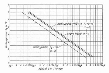
Bild 3. Temperaturverlauf in Funktion der Zeit an der Oberfläche eines Hohlzylinders, einer Hohlkugel und einer ebenen Wand von  $8 \,^{\circ}$  C Ursprungstemperatur bei Kühlung durch Luft von  $0 \,^{\circ}$  C. (a = Wärmeübergang von der Felsoberfläche an die Luft)
