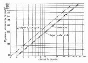
Bild 5. Mit einem Luftstrom von 0  $^{\rm 0}$  C von einer Sandsteinoberfläche von 1 m² und 8  $^{\rm 0}$  C Anfangstemperatur abgeführte Wärmemenge in Funktion der Zeit
