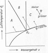
Bild 6. Nebelisotherme im Ix-Diagramm für feuchte Luft, Bezeichnungen im Text
