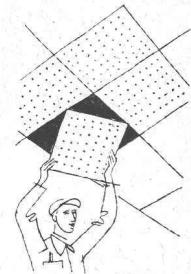
ZENT-FRENGER wird als Unterdecke aufgehängt und ist leicht zugänglich. Elektrizität, Wasser usw. können unsichtbar montiert werden.
