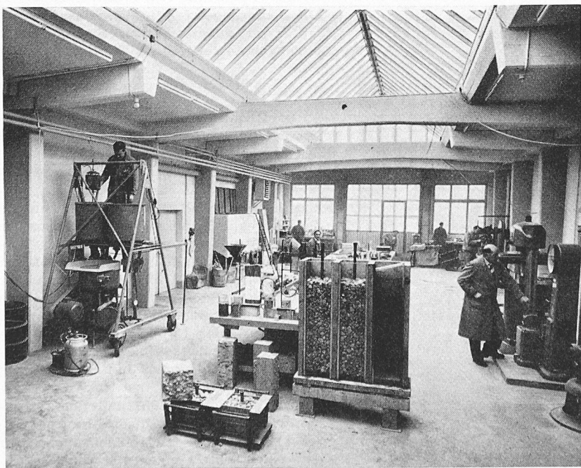
Materialprüfanstalt der Firma Kaspar Winkler & Co., Tüffenwies 12, Zürich-Altstetten. Links Herstellung des Injektionsmörtels mit Intraplast Z , in der Mitte Kiesgerüste zur Demonstration des Intracrete -Verfahrens.
