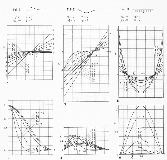
Bild 3. Diagramme der Spannungskoeffizenten, oben  $S_b$  unten  $S_t$  für die drei Grundfälle in Funktion der Verhältniszahl  $\xi=x\hbar$
