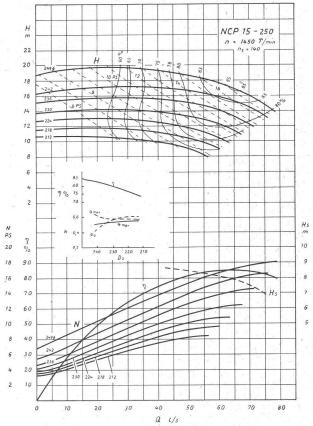
Kennlinien einer Spiralgehäusepumpe mit verschiedenen Laufraddurchmessern
