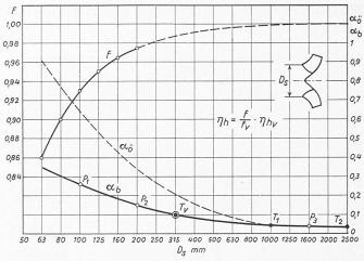
Bild 1. Wirkungsgradaufwertung in Abhängigkeit des Saugmunddurchmessers  $D_{\boldsymbol{s}}$
