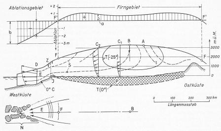
Bild 3 Schematischer Querschnitt durch das Inlandeis längs des West-Ost-Profils (Bild 2), Ueberhöhung 1:50.
