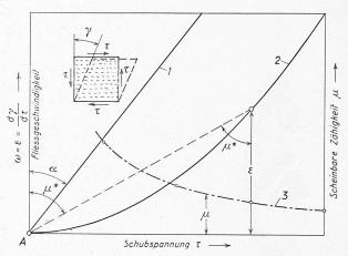
Bild 4 Verformungsgeschwindigkeit ( $\omega$  oder  $\varepsilon$ ) von Eis in Funktion der Scherspannung  $\tau$  (Fliesskurve). Definition der «scheinbaren Zähigkeit»  $\mu$ . Für kurzfristige Beanspruchungen verhält sich Eis wie ein elastischer fester Körper ( $E \sim 20\,000$  kg/cm²), bei langfristiger Beanspruchung dagegen wie eine unvollkommene zähe Flüssigkeit.
