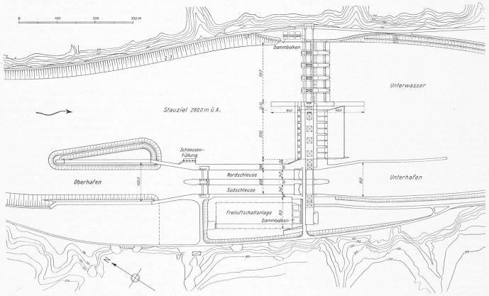
Bild 1. Gesamtübersicht des Donaukraftwerkes Aschach, 1:7000.
