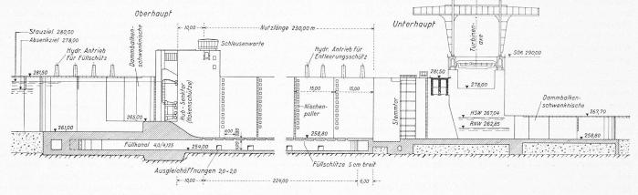
Bild 2 Längsschnitt durch die Südschleuse, 1:1300.
