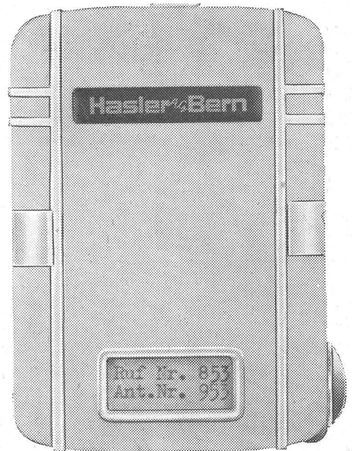
Der Empfänger der drahtlosen Personensuchanlage Hasler in natürlicher Grösse.
