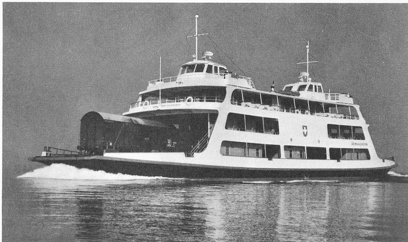
Bild 1. Das Fähr- und Fahrgast-Schiff «Romanshorn» beim Trajektieren von Güterwagen
