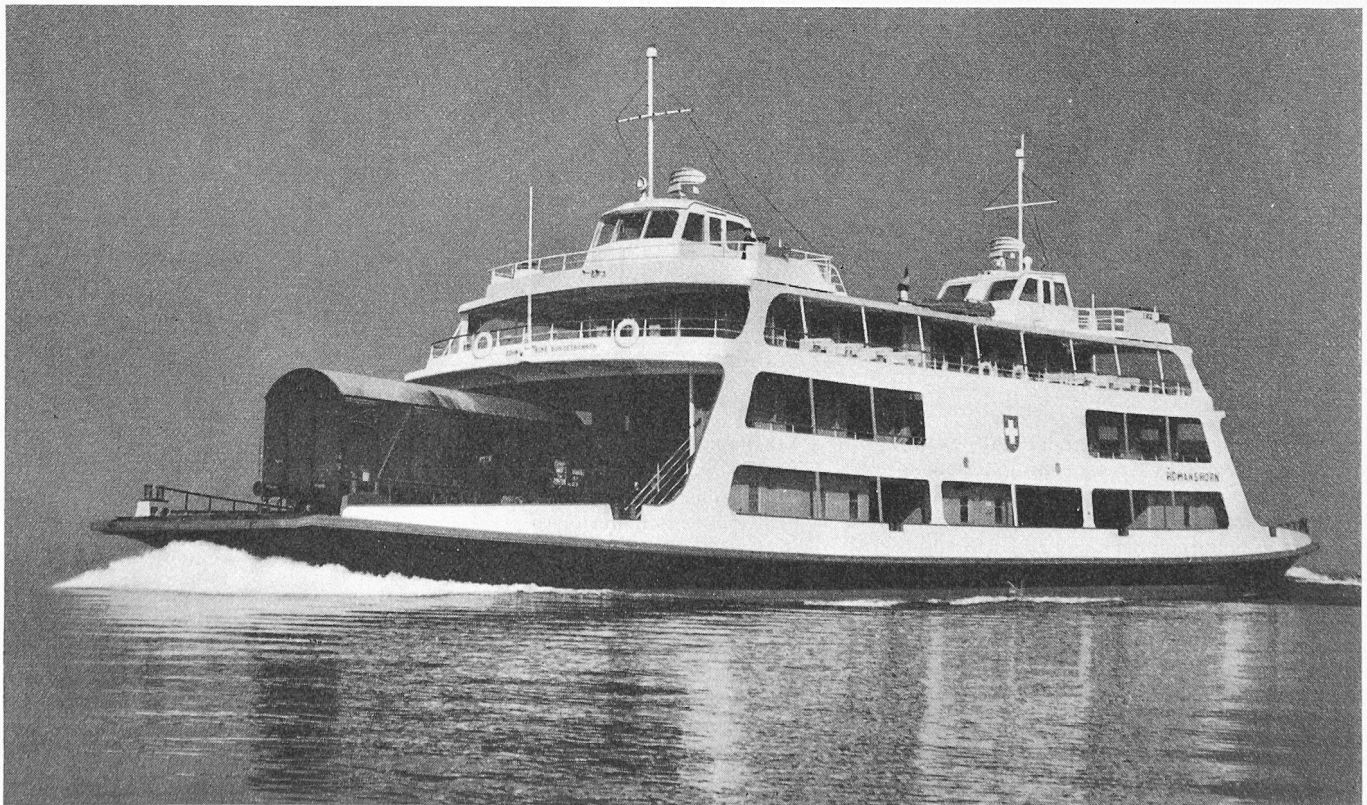
Bild 1. Das Fähr- und Fahrgast-Schiff «Romanshorn» beim Trajektieren von Güterwagen
