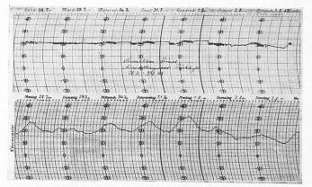
Bild 19. Registrierstreifen der Raumtemperatur (oben) und der Aussentemperatur (unten) für die Zeit vom 28. Juli bis 3. August 1958. (Der 1. August war mit  $31,6^{\circ}$  C höchster Mittagstemperatur der wärmste Tag des Jahres 1958)
