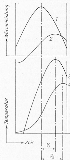
Bild 6. Grundsätzlicher Zusammenhang zwischen Wärmestrahlung (Kurve 1) und Kühllast (Kurve 2) für einen Raum mit Oberlicht. Unten der entsprechende Verlauf der Bodentemperatur bei leichter (Kurve 3) und bei schwerer Konstruktion (Kurve 4). V_1 und V_2 sind die Phasenverschiebungen der Maxima
