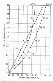
Bild 17. Gewünschter Zusammenhang zwischen Aussentemperatur und Raumtemperatur
