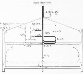
Von der in den Dachraum gelangenden Wärmemenge werden abgeleitet:
