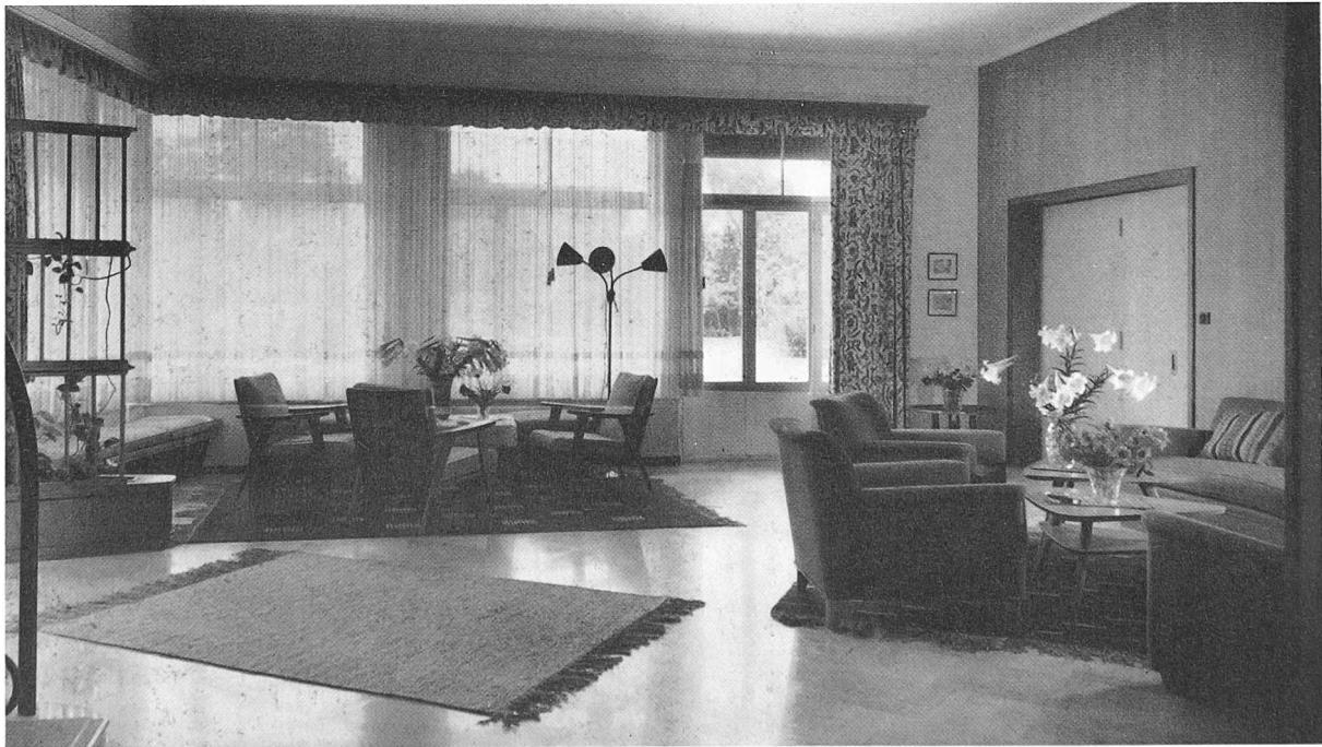
Halle; Blick südlich in den Garten. Rechts Schiebefalttüre zum Salon. Wand rechts mit Flexwood «Ulme» verkleidet, übrige Wände und Decke helle Oelfarbe.
