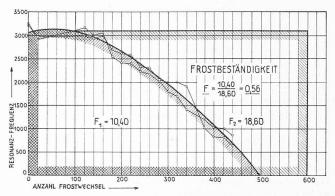
Bild 13. Gemessene Resonanzfrequenz an Prismen  $20/20/60\,\mathrm{cm}$  nach je 20 Frostwechseln
