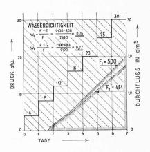
Bild 11. Schema für die Prüfung der Wasserdichtigkeit von Betonproben und deren Charakterisierung durch eine einzige Zahl
