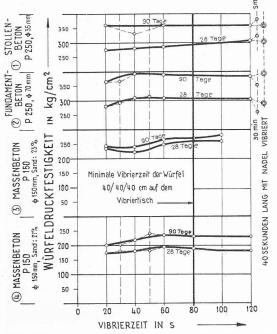
$\operatorname{Bild}$ 8, Einfluss der Vibrierzeit auf dem Rütteltisch auf die Würfeldruckfestigkeit von Beton
