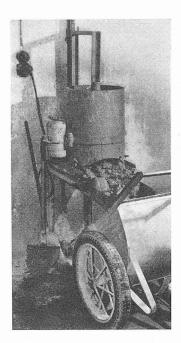
Bild 3. Gerät zur Messung der «Verarbeitbarkeit» von Frischbeton
