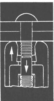
Zunehmende Zugkraft presst die Hülse in die Querrillen des Bolzens.
