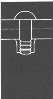
Der so gesetzte Huckbolt bildet über die eingepresste Hülse eine äusserst hochfeste Verbindung.
