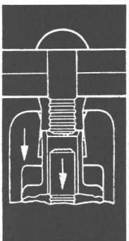
Der Bolzen reisst schliesslich bei einer vorbestimmten Kraft an der Sollbruch-Rille ab.
