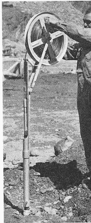
Bild 12. Auf dem Setzungspegel aufgesetzte Messeinrichtung. (Photo Brügger)
