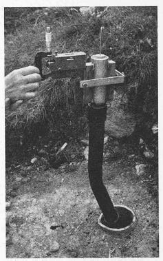
Bild 14. Beobachtungspunkt für geodätische und Klinometer-Messung auf dem Bergrutsch.
