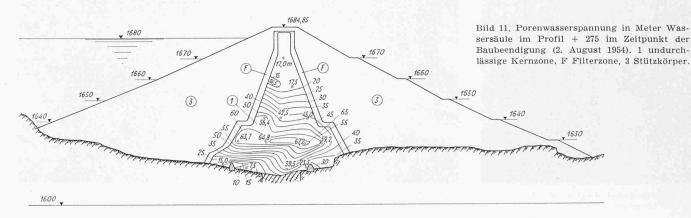
meterablesungen ergeben. Die Zellen in der Kernzone sind zur Hauptsache in zwei Querprofilen konzentriert (über dem Fels bzw. Bergrutsch).
