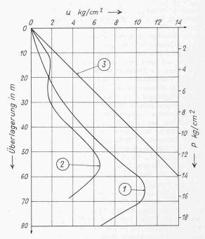
Bild 10. Porenwasserdrücke u in  $kg/cm^2$  in der Axe der Kernzone.
