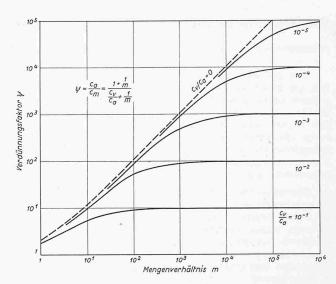
Bild 5. Diagramm über die erreichbaren Verdünnungsverhältnisse in Abhängigkeit vom Mengenverhältnis m und vom Konzentrationsverhältnis  $c_v/c_a$
