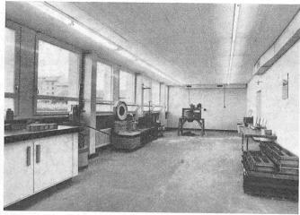
Bild 2. Betonlaboratorium. Von links nach rechts: hydraulische Presse für Druck- und Biegezug-Festigkeitsmessung, Waage, Luftporenmessapparat, Vibriertisch, Zwangsmischer, Schalungen
