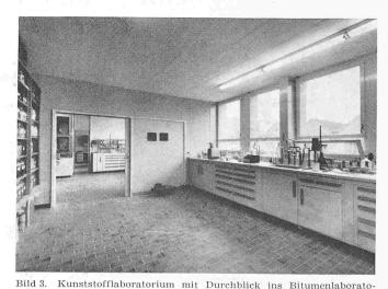
rium und ganz hinten in das analytische Laboratorium, Im Kunststofflaboratorium von r. nach l.: Rührwerk, pH-Messgerät, Mettlerwaage
