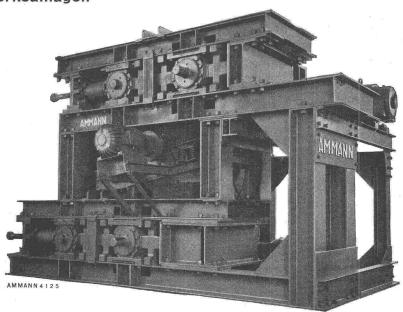
Doppel-Walzwerk mit Vibro-Sieb zwischen den beiden Walzwerken. Jedes Walzwerk sowie das Vibrosieb sind mit elektrischen Einzelantrieben ausgerüstet.
