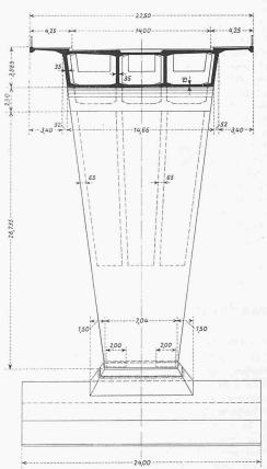
Projekt Nr. 17. Verfasser: P. Soutter, Ing. S.I.A. Zürich, Mitarbeiter W. Schalcher Ing. S.I.A. Architektonischer Berater: E. Schindler, Arch. BSA/S.I.A., Zürich. Längsschnitt 1:1250, Querschnitt 1:400. Baukosten 3,57 Mio Fr.
