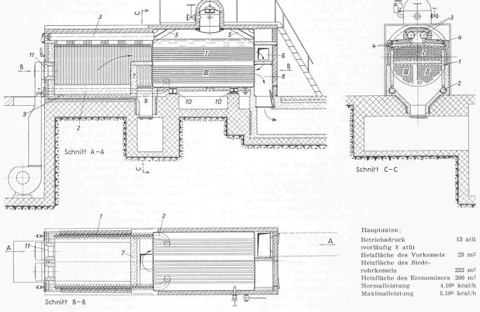
Bild 1. Dreizug-Siederohrkessel mit Wasserrohr-Vorkessel, Bauart SLM, 1:100
