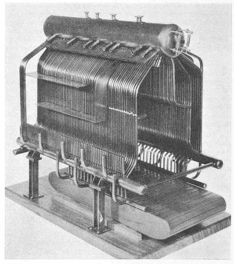
Bild 6. Ansicht des Modells eines Wasserrohr-Strahlungskessels
