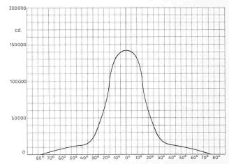
Bild 4. Lichtverteilungskurve des BAG-Scheinwerfers Nr. 175 706 mit Hg-L-2000-W-Lampe
