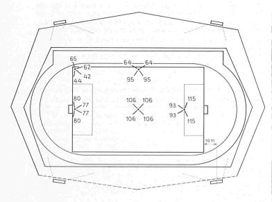
Bild 7. Ausgeführte Anlage Letzigrund, Maststandorte und vertikale Beleuchtungsstärken in Lux in den angegebenen Richtungen
