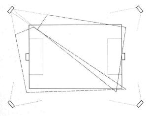
Bild 3. Grossflächige Ausleuchtung eines Spielfeldes, Lichtverteilung von zwei Scheinwerfern eines Turmes
