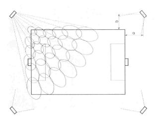
Bild 1 (links). Maststandort und Prinzip der Ausleuchtung eines Spielfeldes mit Scheinwerfern mit eng gebündeltem Lichtkegel. Masse a und b nach örtlichen Verhältnissen
