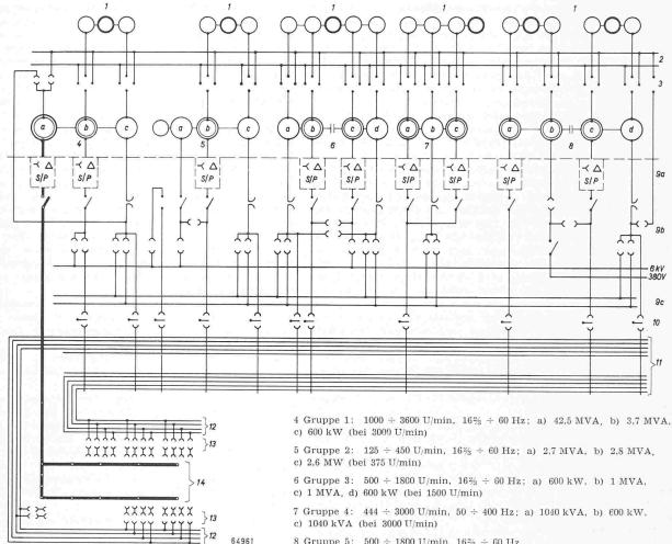
Bild 18. Einpoliges Gesamtschaltschema des Energieverteilsystems
