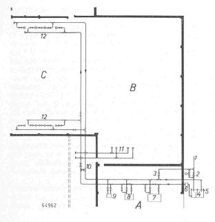
Bild 22 (links). Schaltschema der Kühlwasseranlage
